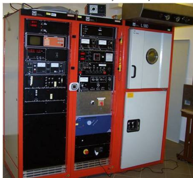
Rys. 4. Uniwersalne urządzenie do osadzania cienkich warstw metodą magnetronowego rozpylania katodowego i z działu elektronowego L560.
