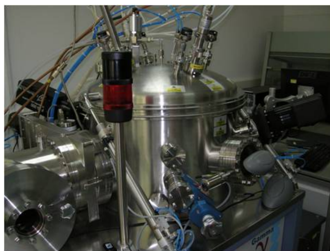
Rys. 3. Urządzenie do osadzania cienkich warstw metodą PVD-MS, Gamma 1000 Surrey System.
