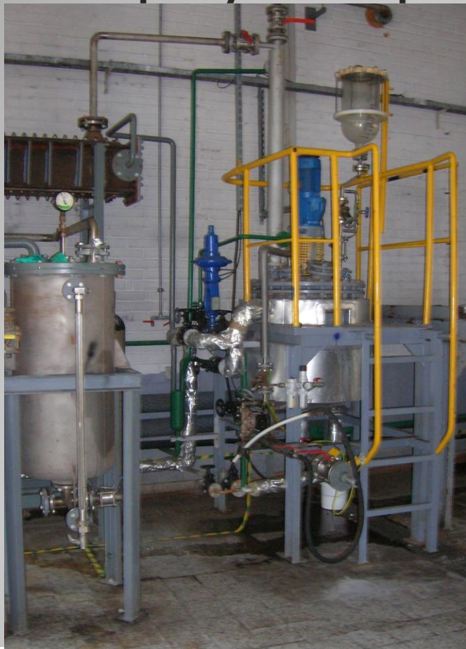
Widok ogólny instalacji do syntezy nanokrzemionek w procesie zol-żel wyposażonej w reaktor emaliowany V-200 litrów
